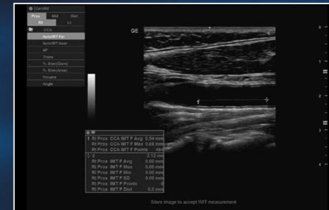
Auto IMT автоматически измеряет толщину комплекса интима-медиа на дальних и ближних стенках сосудов.
